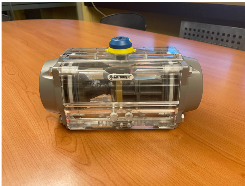
Figura 1.3: Modellino a scopo didattico di un attuatore pneumatico AirTorque.
