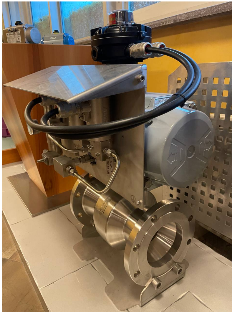
Figura 1.1: Modello di sistema di controllo: pannello di controllo, attuatore e valvola a sfera.
